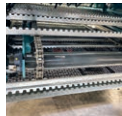
Aufnahmeschar mit Transportsystemeinheit
