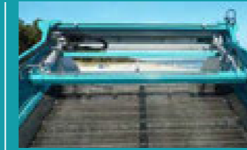
Nastro setaccio ➤ Nessun allungamento (non è necessario alcun accorciamento) ➤ Maggiore durata ➤ Nessun sovraccarico ➤ Non è più necessario un tenditore
